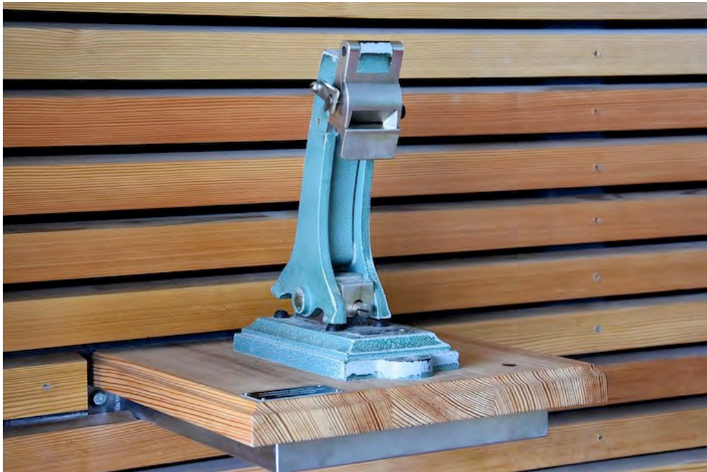
Der Gast kann sein Kartonsillett anschliessend mit dieser Prägemaschine mit dem Datum versehen.
